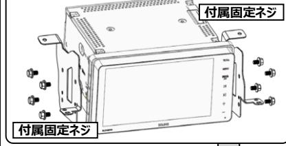
① 車両のオーディオ、小物入れ等を取り付けているブラケットを取り外し、本体にこのブラケットを取り付けます。(付属固定ネジ)
