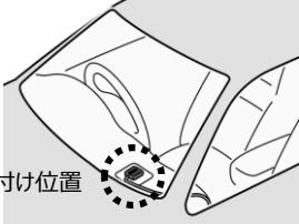
GPSアンテナ裏面に両面テープを貼り付け推奨場所へ設置してください。
