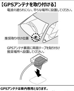
GPSアンテナは車載機器(※1)および各アンテナ類 (※2) から 50cm 以上離して設置してください。 車載機器や各アンテナ類の近くに取り付けると、GPSが 正常に機能せず、電波を受信しにくくなったり、誤動作を 起こす可能性があります。
